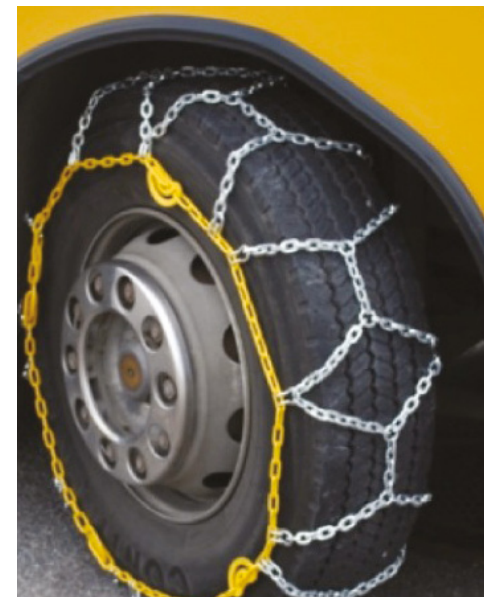
6 Stram kjettingen ved å vri over de 4 cam-locks med vedlagt strammenøkkel
